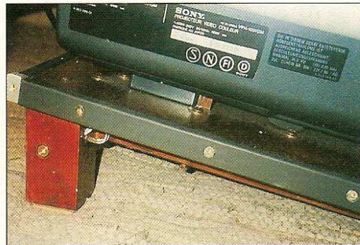
A gauche, le projecteur tri-tubes Sony VPH 1031 QM, placé sous une table basse avec dessus en verre. On voit, ci-dessus, les cibles pour le calage dans les trois dimensions du projecteur par faisceau laser.
