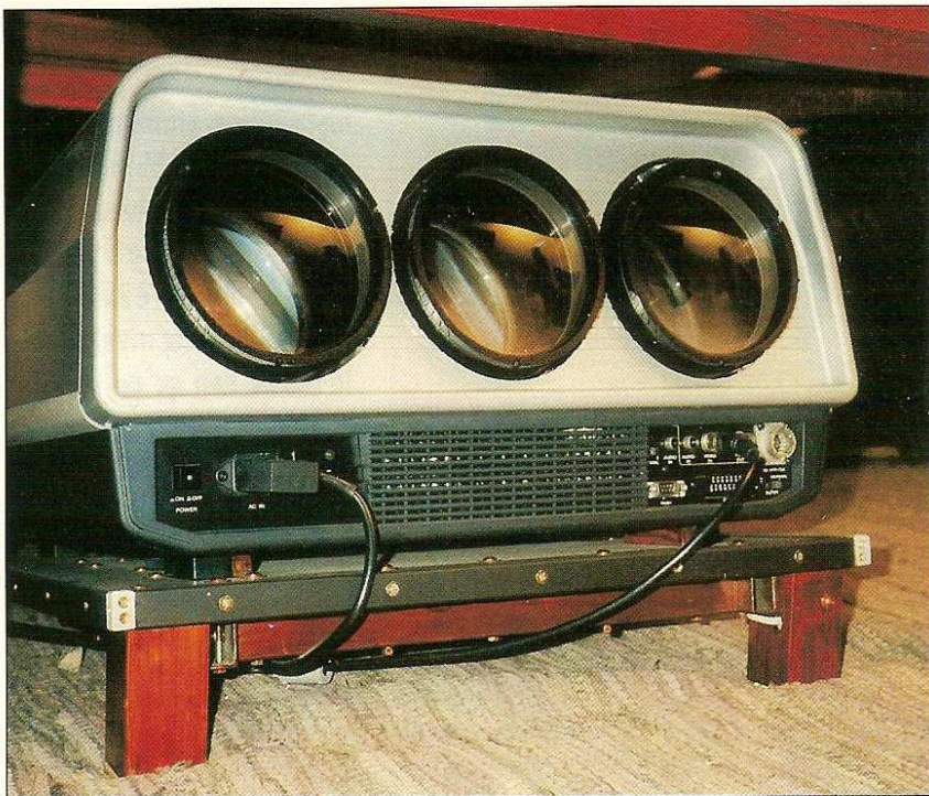
A gauche, le projecteur tri-tubes Sony VPH 1031 QM, placé sous une table basse avec dessus en verre. On voit, ci-dessus, les cibles pour le calage dans les trois dimensions du projecteur par faisceau laser.
