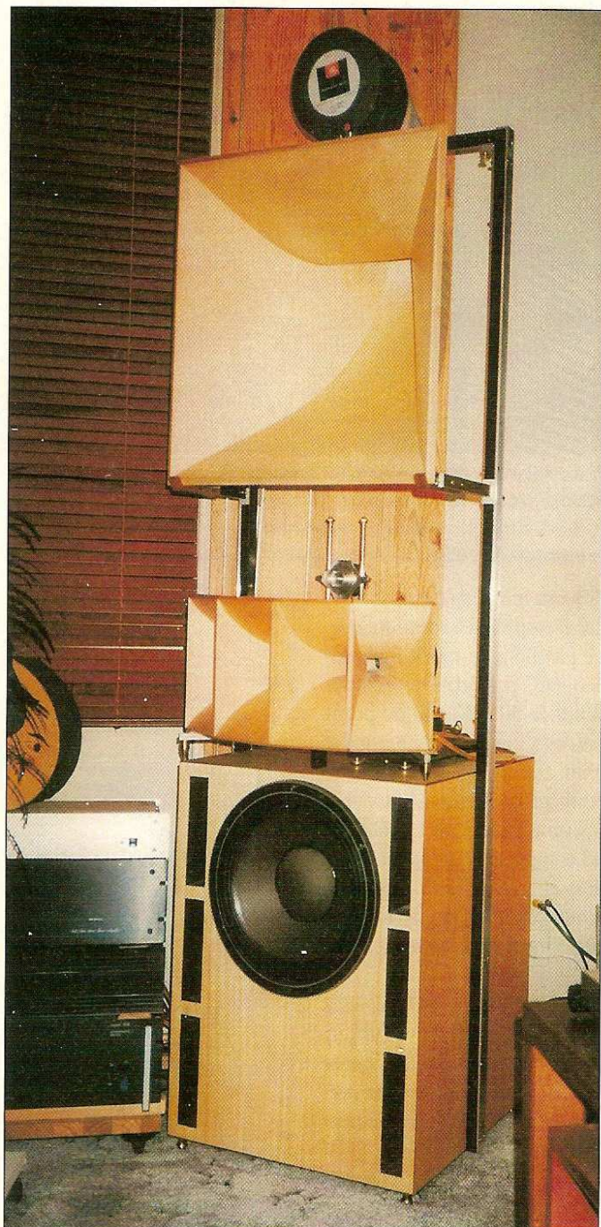
L'ensemble des haut-parleurs des voies principales est solidaire d'un bâti rigide intérieurement sablé, pourvu de possibilités de réglage en hauteur et en profondeur.
