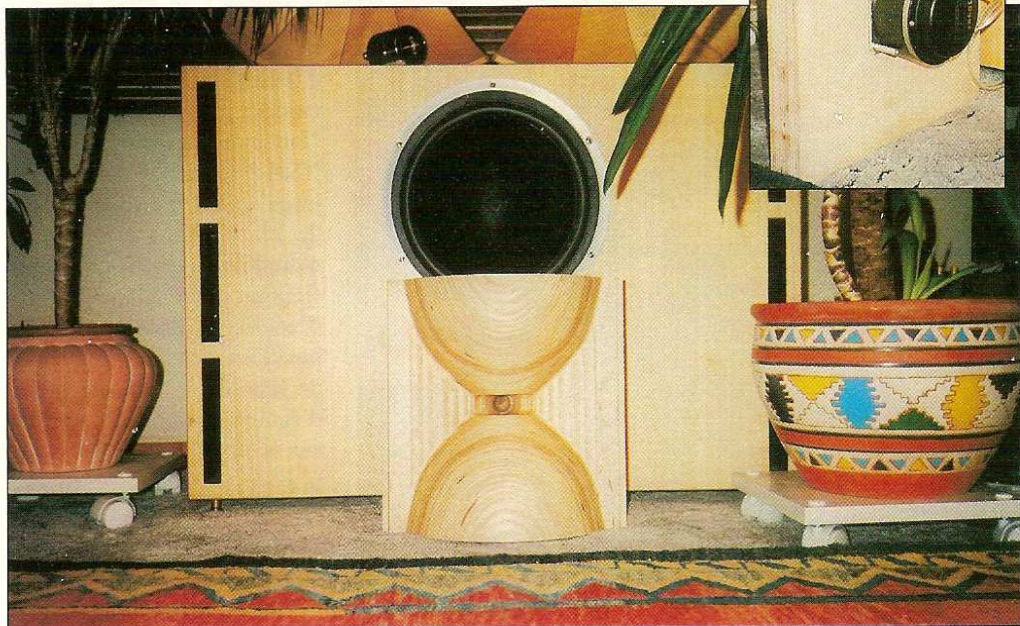
Ci-dessous, la voie d'extrême-grave pour la restitution des fréquences comprises entre 25 et 45 Hz. Devant celle-ci, le pavillon bi-radial en bois lamellé usiné dans la masse utilisé pour la voie centrale. Le choix de la chambre de compression associée n'est pas encore définitif.
