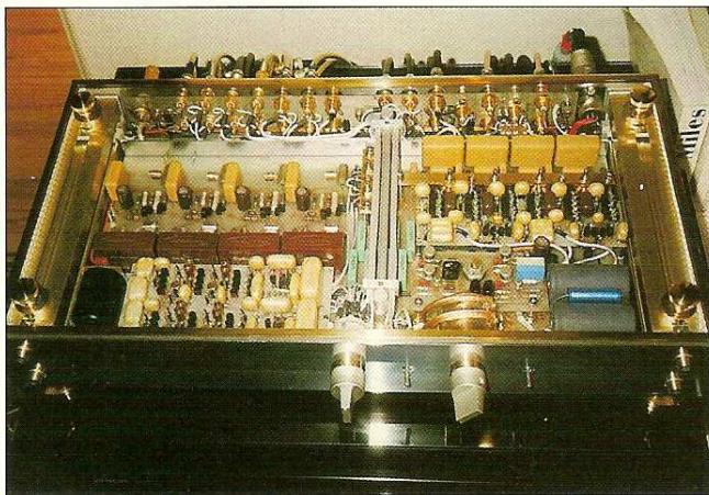
Un vrai chef-d'œuvre digne des plus belles réalisations High end américaines : le préamplificateur/filtre actif de Thierry Prévost. Le contrôle de volume, lui aussi une réalisation "maison", est un atténuateur à plots composé de nombreuses résistances calibrées. De nombreux condensateurs ont été amortis par un enrobage de résine époxy.
