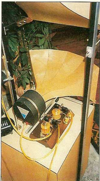
Ci-dessous, vue arrière de la voie de médium-aiguë confiée au moteur TAD TD 2001, situé à proximité du super-tweeter ESS-Heil à "transformateur acoustique".
