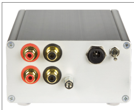
Figure 8. La pose des prises de raccordement et de l'interrupteur sur le panneau arrière.
