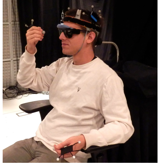
FIGURE 4.3 – Photos d’un sujet réalisant la tâche de pointage proximale. Le sujet porte un objet de pointage dans chaque main avec le marqueur de référence tenu au bout des doigts. La tête est supportée par un appui-tête (c.f figure de droite) pour éviter les mouvements de la tête, et est repérée en temps réel par un système de suivi de position, de même que les objets de pointage. Le sujet utilise la main de son choix pour pointer en laissant l’autre au repos (bras posé sur l’accoudoir).
