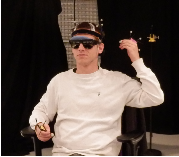
FIGURE 4.3 – Photos d’un sujet réalisant la tâche de pointage proximale. Le sujet porte un objet de pointage dans chaque main avec le marqueur de référence tenu au bout des doigts. La tête est supportée par un appui-tête (c.f figure de droite) pour éviter les mouvements de la tête, et est repérée en temps réel par un système de suivi de position, de même que les objets de pointage. Le sujet utilise la main de son choix pour pointer en laissant l’autre au repos (bras posé sur l’accoudoir).
