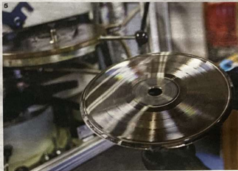
Afin d'obtenir le parfait vinyle, macaron central compris (3), deux éléments se révèlent essentiels : la matrice, un moule en nickel marqué de sillons (5), et des copeaux de plastique noir (4).
