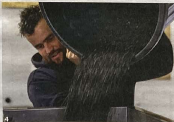
Afin d'obtenir le parfait vinyle, macaron central compris (3), deux éléments se révèlent essentiels : la matrice, un moule en nickel marqué de sillons (5), et des copeaux de plastique noir (4).
