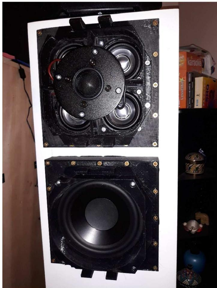
La seconde amélioration a donc visée l'atténuation de la diffraction par l'ajout d'une forme de pavillon.
