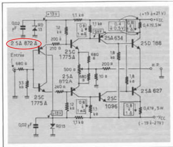
Fig. 1 : Schéma de l'amplificateur 20 W, version définitive, comportant quelques légères modifications par rapport à la description parue dans les numéros 10 et 11.
