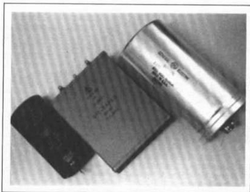
Fig. 28 : Condensateurs utilisés pour l'alimentation. A gauche un modèle de valeur 500  $\mu$ F 450 V. Au centre un condensateur au papier huilé (marque SIC-SAFCO) de valeur 10  $\mu$ F 600 V. A droite un condensateur de valeur 2,200  $\mu$ F 450 V (marque General Electric). Ces condensateurs peuvent être utilisés sur le premier étage, alimenté par 400 V.
