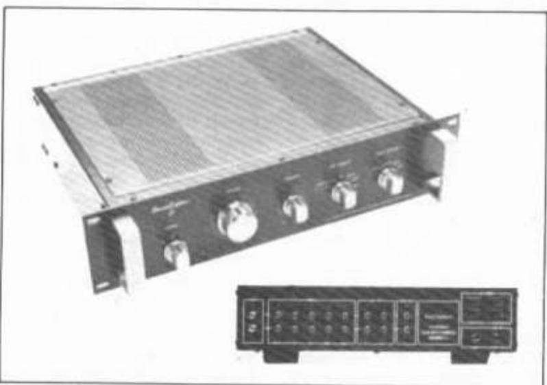
*Fig. 24 : Châssis standard, préperçé et comportant des cloisons internes, d'origine japonaise et de référence EL 880 MK 2. La hauteur interne du châssis étant de 97 mm il convient parfaitement pour les préamplificateurs à tubes. Sa présentation en rack est très élégante.*
