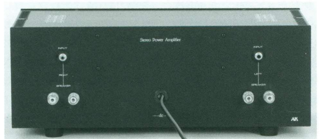
パワー IVC基板を左右の放熱器に取り付けているため、入力と出力端子は左右に振り分けて取り付けられている。ACコードはダイエイ電線50芯を使用
