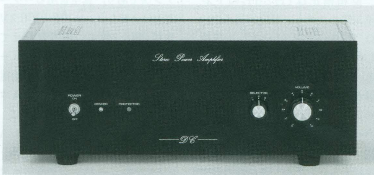
フロントパネル左に電源スイッチとパワーおよび保護回路の表示、右に D/A コンバーターの出力レベルコントロールと入力切り換えスイッチを配置
