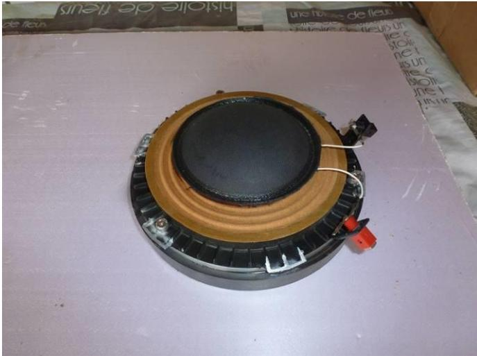
tu pourras remarquer les 3 vis à 120° servant de fixation à la plaque de champ/aimant sur la carcasse du HP..... cette disposition me permet de fixer cette fameuse couronne noire en résine sur les trous taraudés existants en remplaçant les vis acier d'origine par des vis inox adaptées en longueur afin de ne pas "attaquer" l'aimant.
