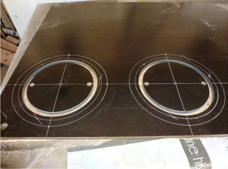
Tracage des rondelles et l'outil qui va bien ( défonceuse en ARplan)
