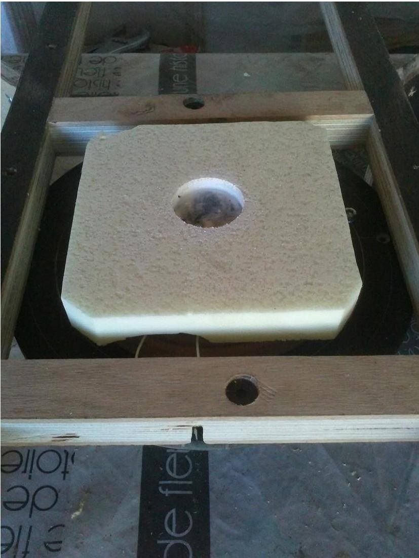
Alignement de la pièce de liaison (règle de maçon) pour un bon parallélisme, ainsi que la distance bobine mobile membrane de l'infraclex :
