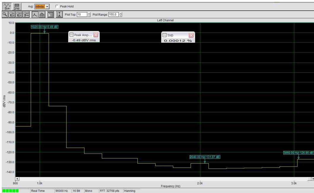
Fig065. Amplificateur L 3.6V 16,8 \mu\text{F} : H2 -131 dB, H3 -127 dB, THD 0,00012%.
