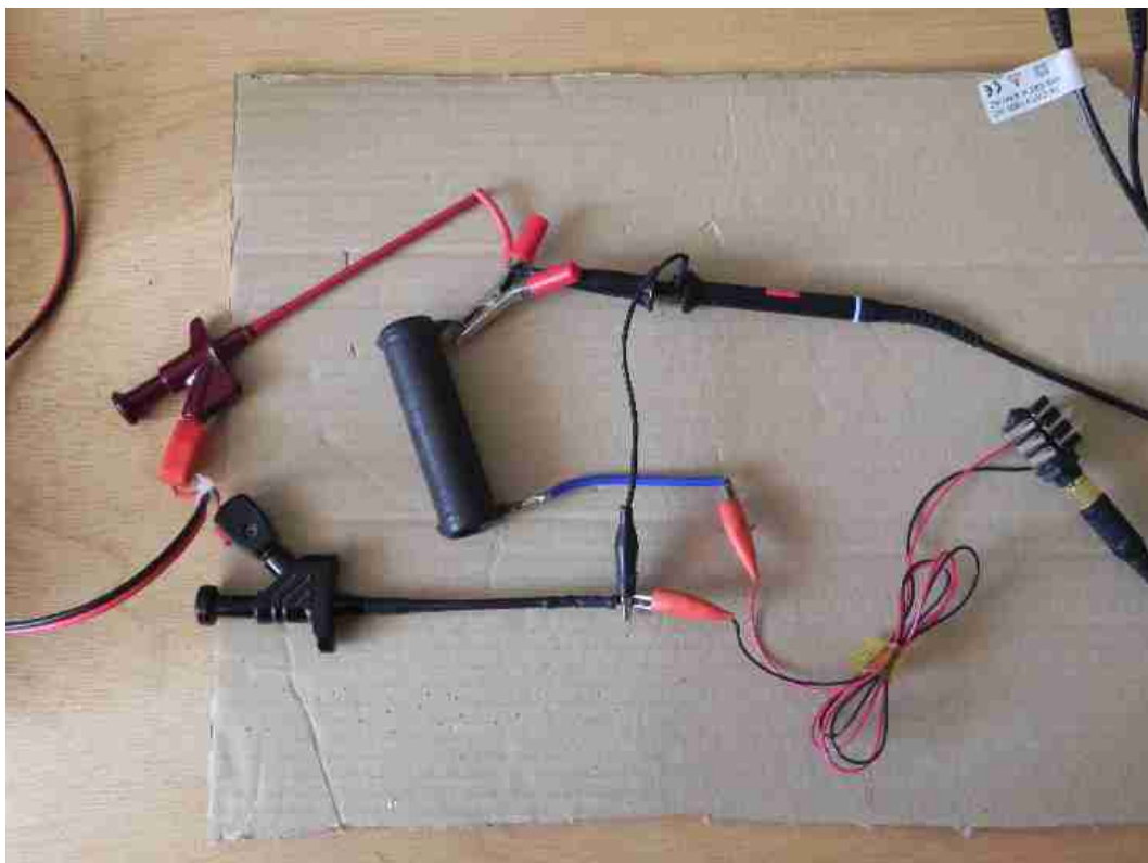
Fig023. Vue rapprochée de la connexion du canal droit au casque avec mise en série d'une résistance de 8 Ohm. Les canaux gauche et droite du jack 6,35 mm sont reliés ensemble.
