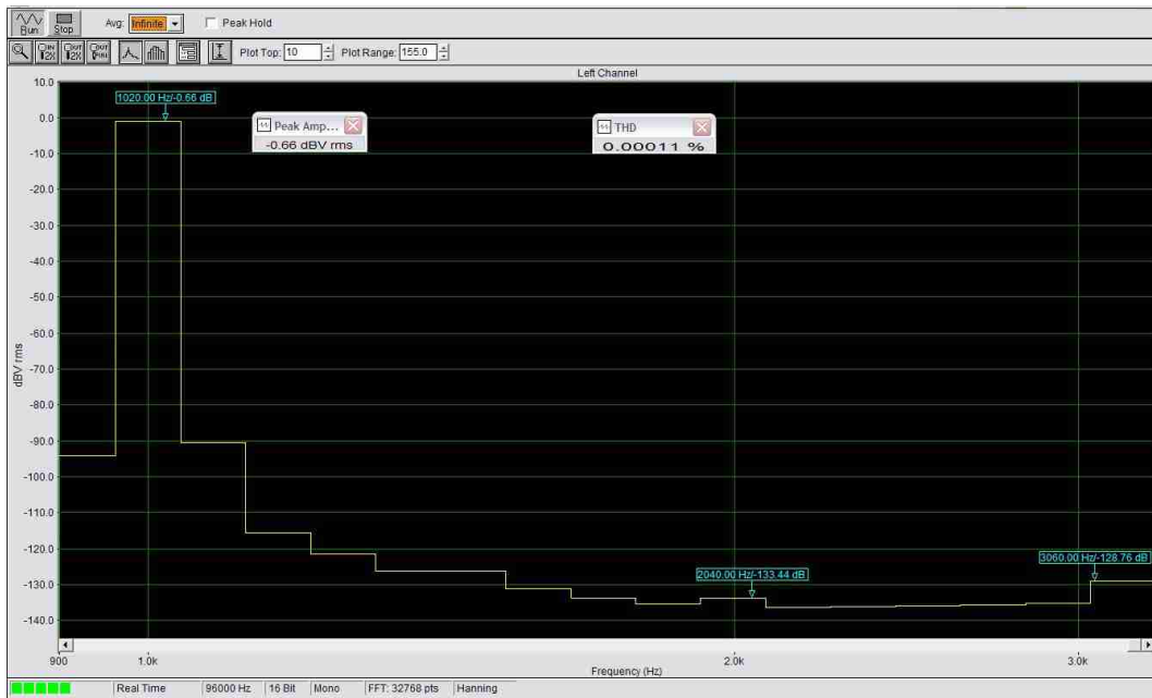
Fig061. Amplificateur L 3.6V à vide: H2 -133 dB, H3 -129 dB, THD 0,00011%
