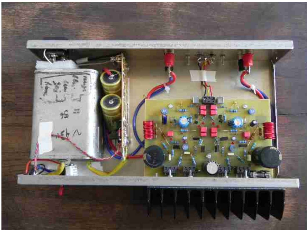
Fig003. La liaison de masse au boîtier se fait sur la vis au centre du circuit imprimé. Il y a d'autres possibilités.
