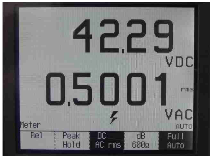
Fig028. La tension d'alimentation chute et l'ondulation augmente.
