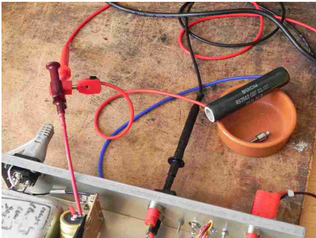
Fig027. Branchement de la résistance de puissance de 39 Ohm sur l'alimentation.
