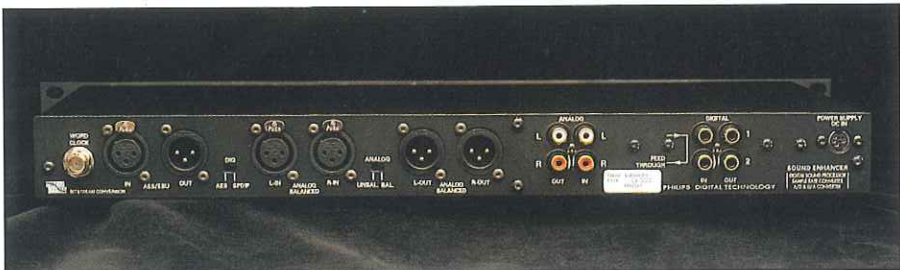
La connectique de l'IS5022 est très complète, car ce processeur propose des entrées et sorties analogiques et numériques symétriques et asymétriques (l'IS 5021, version grand public, ne dispose que d'une connectique asymétrique).
