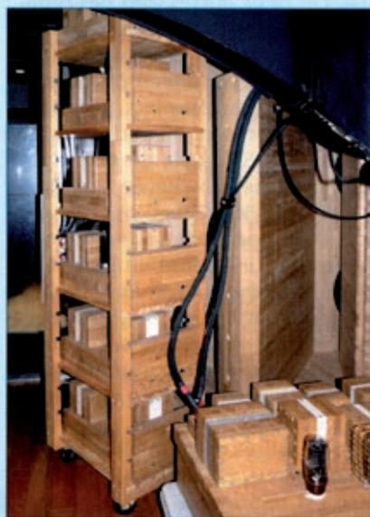
Fig. 9. L'ensemble des différentes sections du filtre passif quatre voies est monté au sein de boîtes en bois sur des étagères d'un rack en bois également afin de limiter tous les effets néfastes de distorsions électro-magnétiques que produisent boîtiers, étagères et rack en métal. Au premier-plan, l'un des amplificateurs de type montriode avec châssis et caches des transformateurs et selfs en bois eux aussi pour les mêmes raisons. A l'écoute, la différence est très notable.
