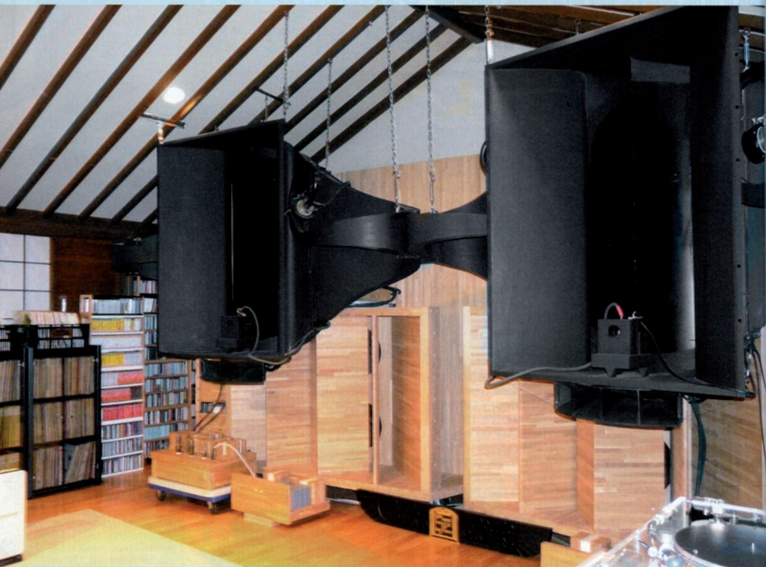
Fig. 5. La vue de côté du système de haut-parleurs avec, derrière les pavillons repliés WE 16A, une vue partielle des haut-parleurs de grave masqués frontalement par des pavillons repliés en forme de "W" inversés.
