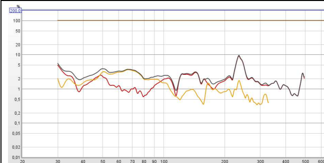
Ci-dessus la distorsion mesurée à 4m pour une puissance injectée de 200W (39,5V). On atteint près de 4% vers 50Hz.
