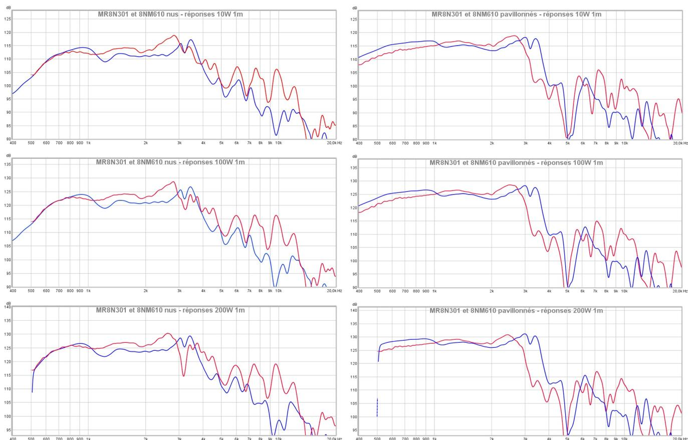
Les deux HP ne réagissent pas identiquement à la présence du pavillon. Ce dernier a sur les deux un effet de régularisation de la courbe de réponse.
