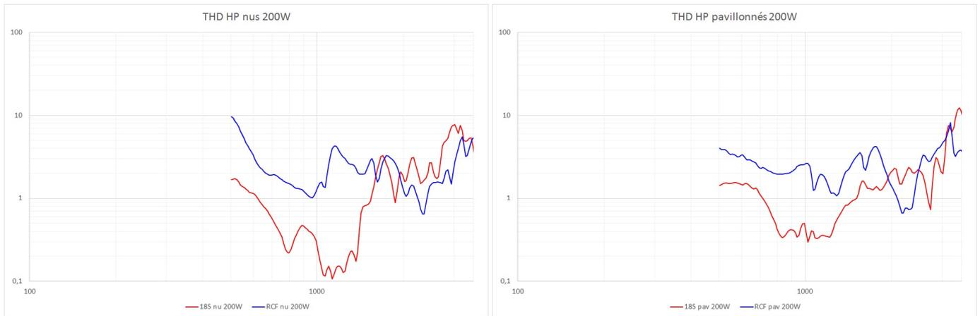
Sur le critère de la THD, la comparaison est impitoyable, et le 18 Sound creuse l'écart, surtout si l'on concentre l'attention sous 2000 Hz.
